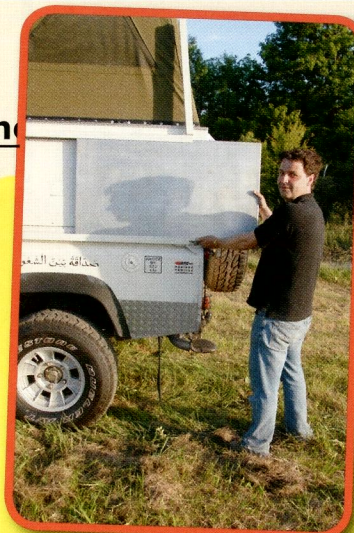
Tischlein deck dich: Tischhalterung an der linken Fahrzeugseite. Eigenkonstruktion: Klappstisch aus Leichtmetall
